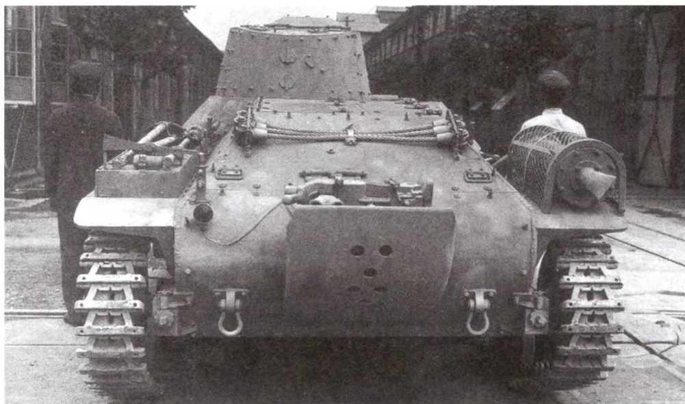
Опытный средний танк «Чи-ни», вид сзади. Танк сохранил «хвост» — для такой машины уже рудиментарный
