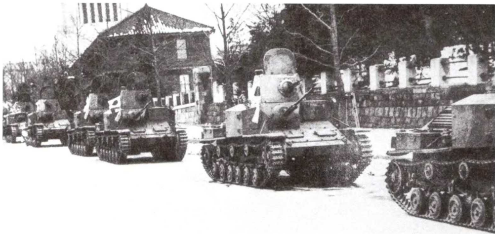
Легкие танки Тип 92 на марше. В корпусе танка установлен 13-мм пулемет
