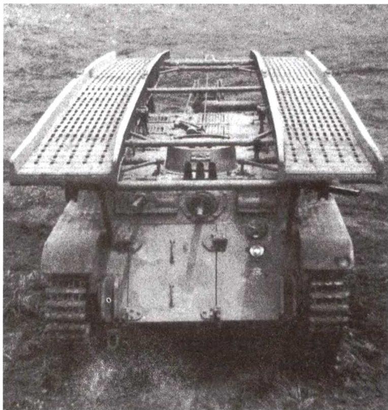
Инженерная бронированная машина SS «Бо Гата» с колейным мостом. Обратим внимание, что и здесь сохранены брандспойты огнеметов
