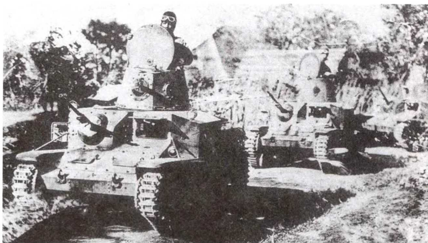
Легкие танки Тип 92 на марше. В корпусе танка установлен 13-мм пулемет
