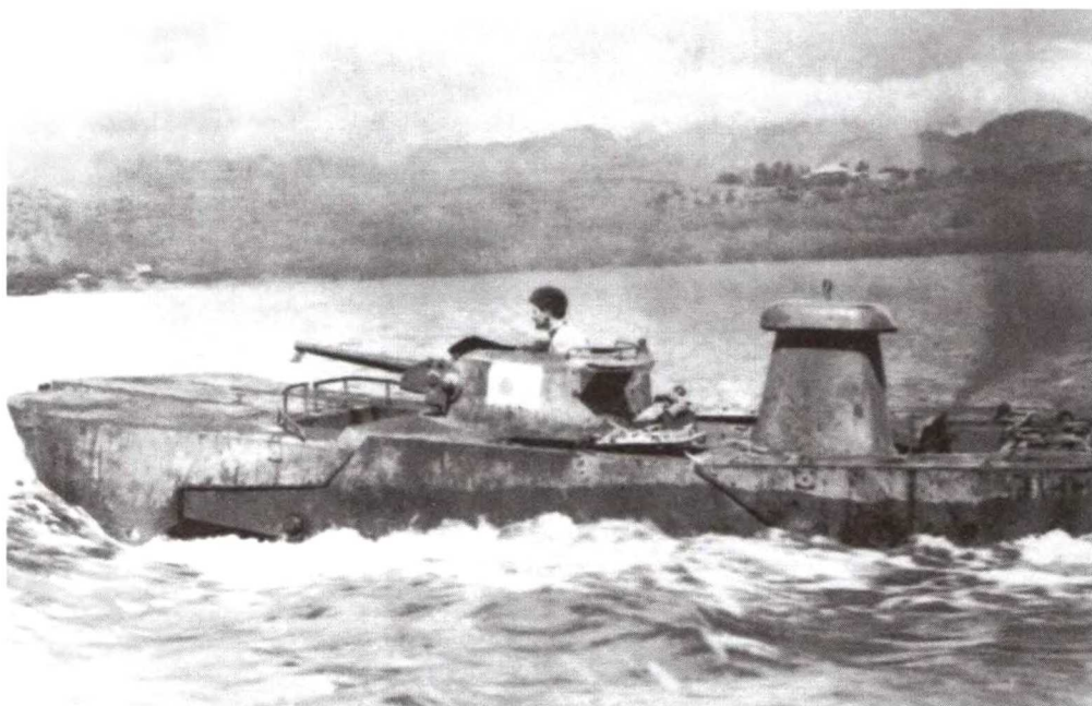
Американцы испытывают трофейный танк Тип 2 «Ка-ми». Видны неплохие мореходные качества машины. Защитный купол башни отсутствует
