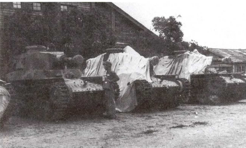
Танки «Чи-ха» артиллерийской поддержки морских десантных отрядов со 120-мм орудием в башне, взятые американскими войсками
