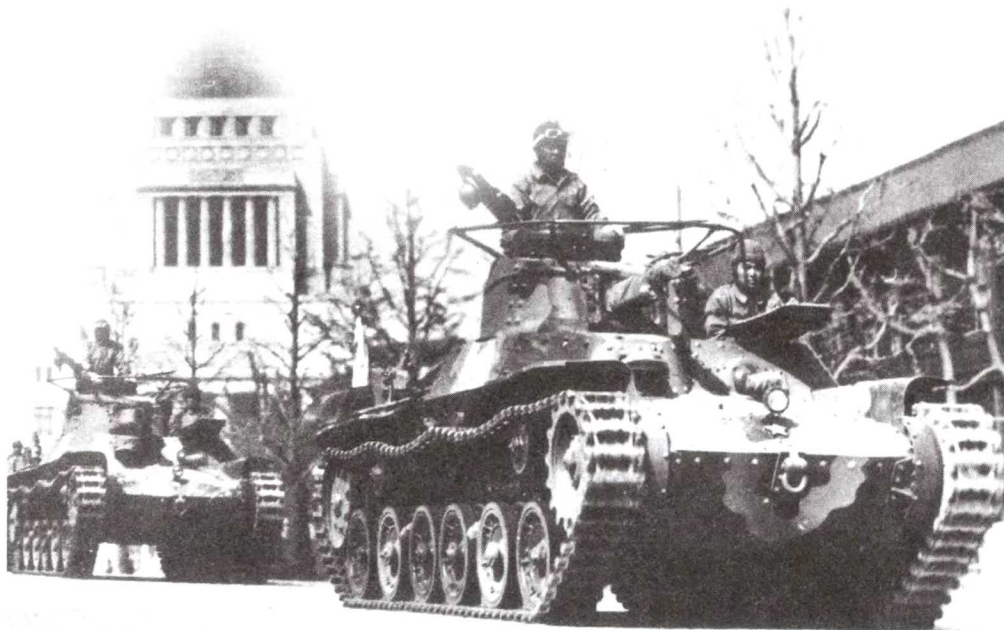
Командирские танки «Чи-ха» с поручневой антенной на башне в парадном строю
